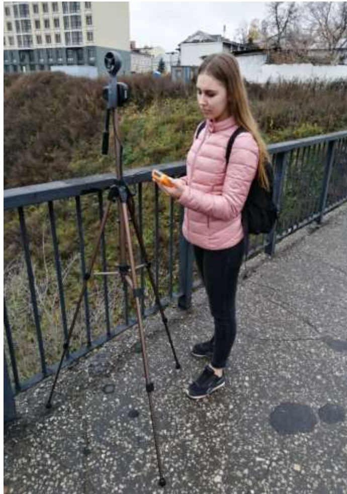
Рис. 1. Измерения температуры и скорости ветра с помощью анемометра Мегеон 11005.
